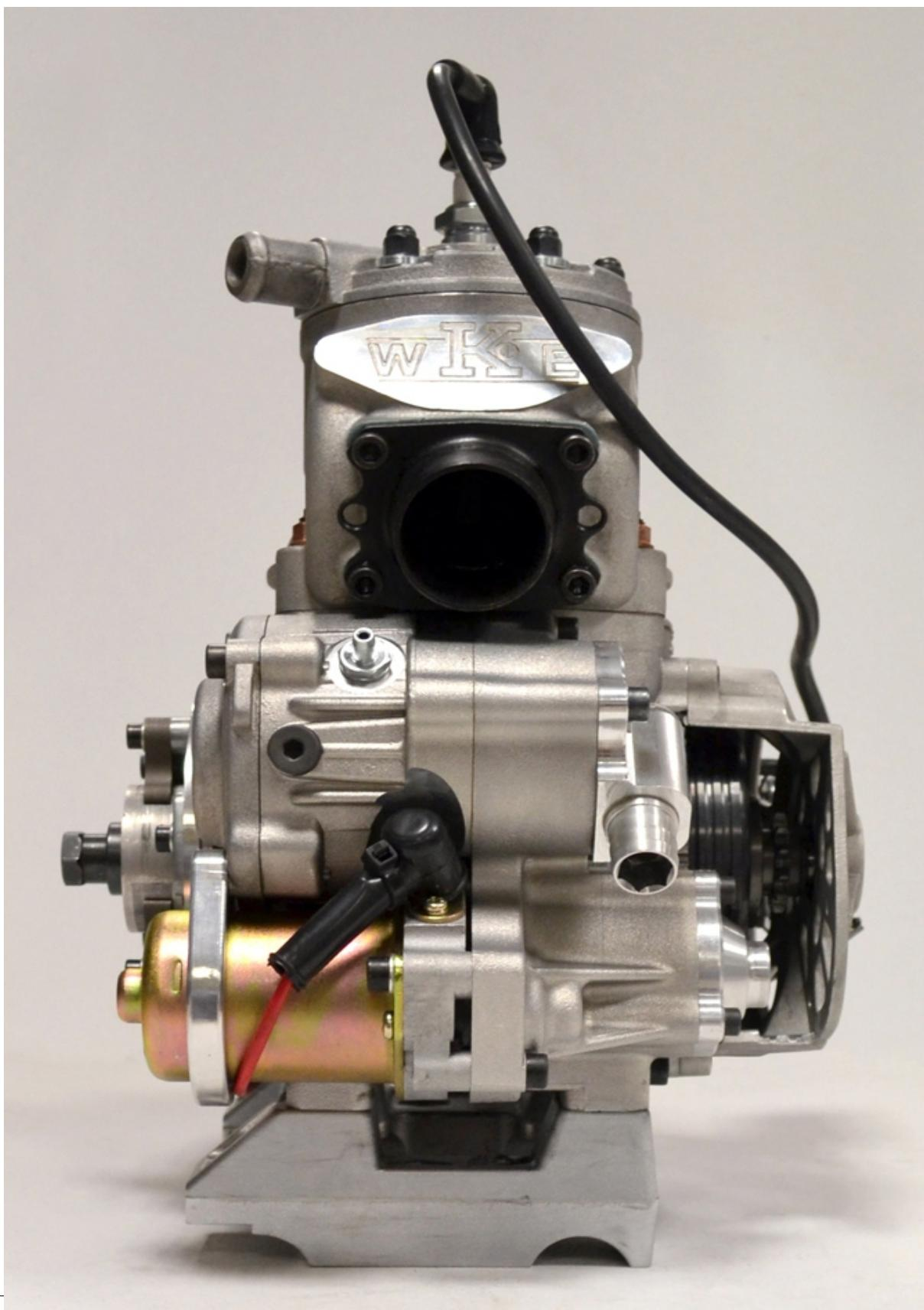
PHOTO DE L'AVANT DU MOTEUR COMPLET
